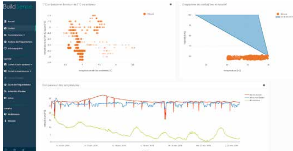
La technologie Buildsense de la société Ecotropy permet de suivre les performances énergétiques d'un centre aquatique en temps réel, d'optimiser les réglages, d'anticiper les besoins, gérer les alertes et réaliser un reporting précis.
